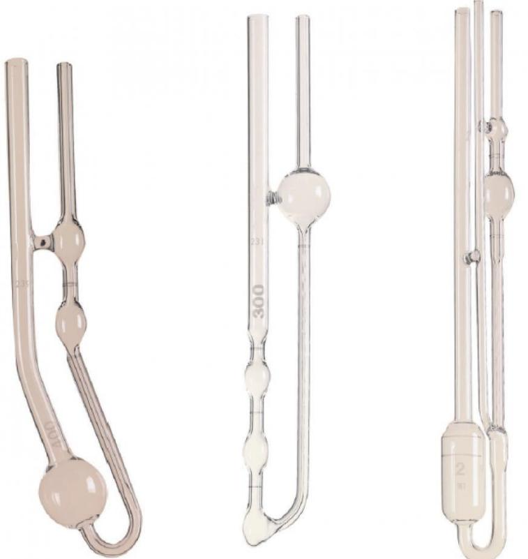
El **propósito** principal de esta norma es medir la resistencia de un líquido a fluir bajo la fuerza de la gravedad a una temperatura controlada con precisión
